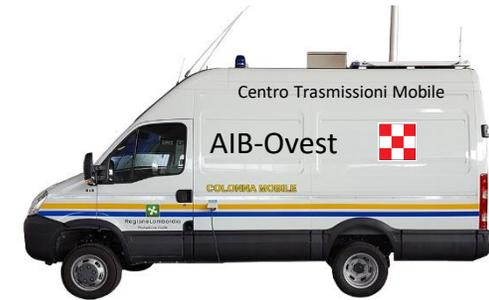
Sono stati allestiti due CTM-R AIB a disposizione dei DOS per il coordinamento delle attività di contrasto degli incendi boschivi. Sono dotati di ripetitore analogico e apparati veicolari TBT per consentire agli operatori di comunicare con i mezzi del COAU.
